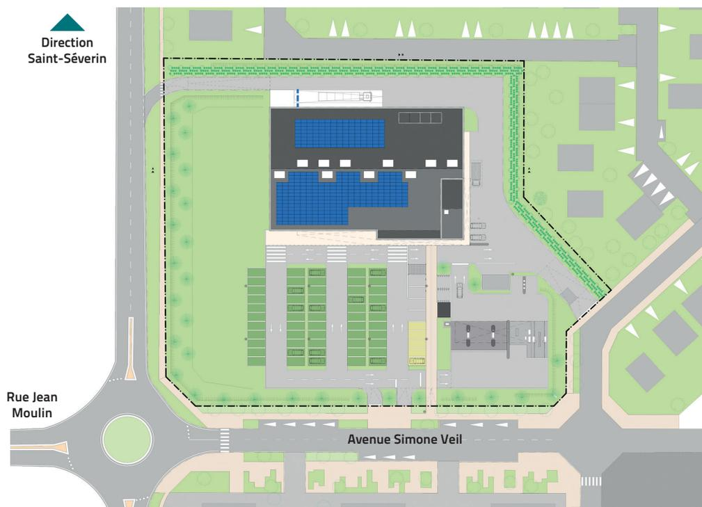
La toiture sera équipée de panneaux photovoltaïques qui assureront l'autoconsommation en journée du magasin. Les places de stationnement devant le supermarché seront perméables pour faciliter l'infiltration des eaux de pluies dans le terrain.
